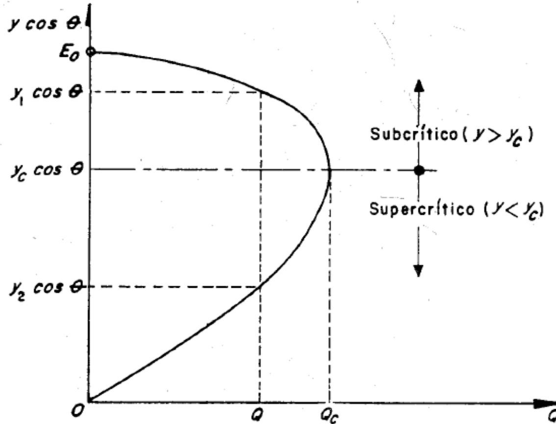
Figura 3.2. Curva gasto-tirante para energía específica constante, en un canal con pendiente. Si  $\theta$  es pequeño,  $\cos \theta \approx 1$
