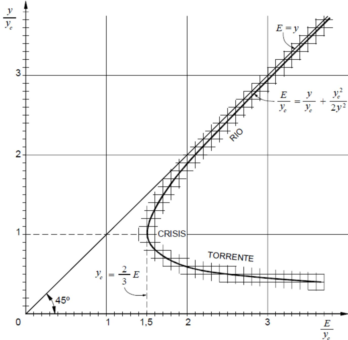
Diagrama adimensional de la Energía Específica en canal rectangular
