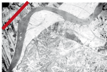
Figura Nº 6. La migración del meandro amenaza la estabilidad de un camino próximo
