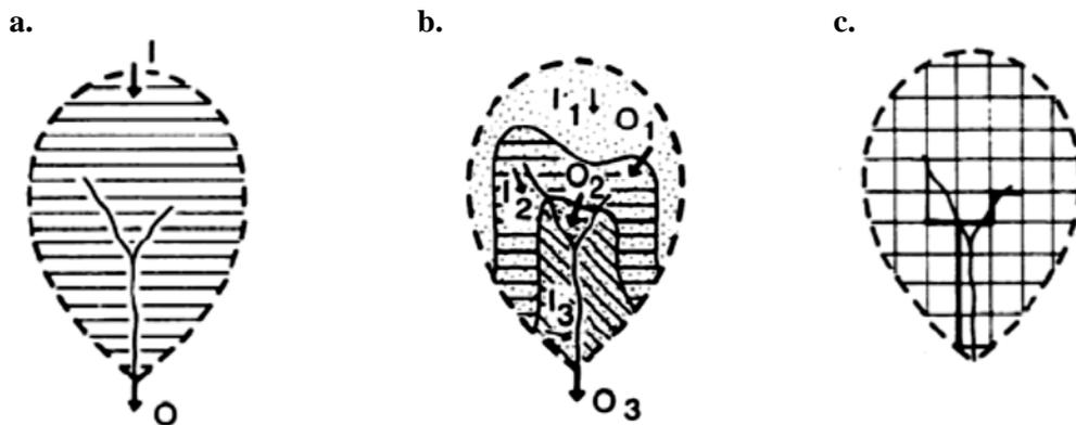
Figura 6 : Clasificación de modelos hidrológicos de acuerdo a su representación espacial. **a)** Modelo agregado. **b)** Modelo Semidistribuido. **c)** Modelo Distribuido
